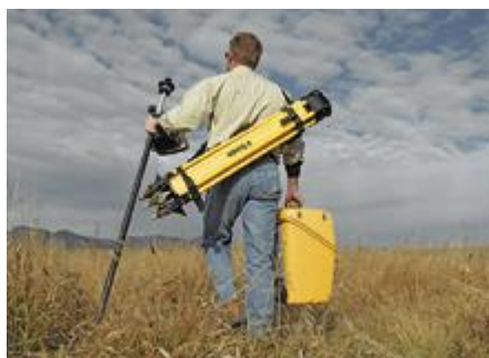
Levantamientos topográficos: en el modo robótico, una sola persona puede medir y registrar puntos tan rápido como pueda caminar.
